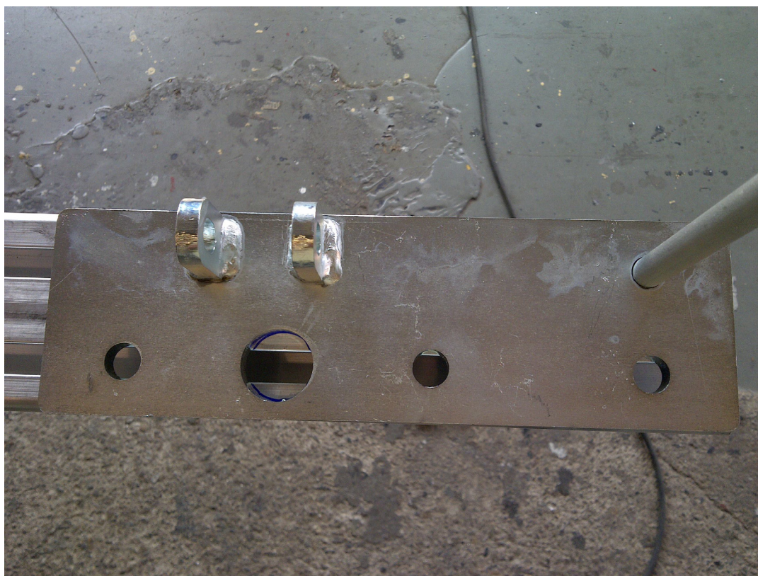
Zadní horní montážní sada, bez závitové desky, spodní pohled
