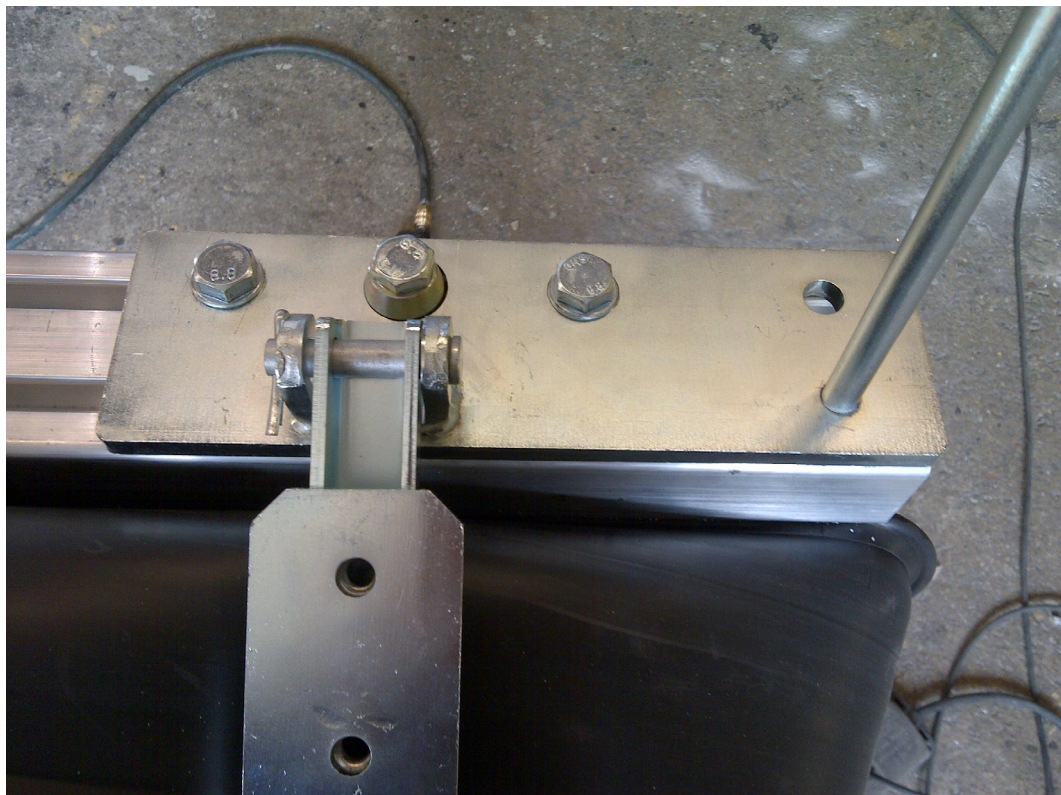
Zadní horní montážní sada, bez závitové desky, spodní pohled s držákem
